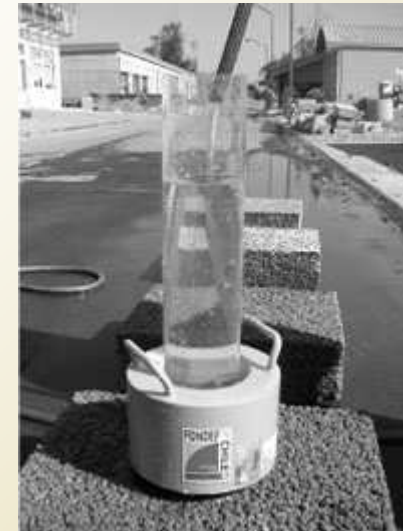
Ensayo con permeámetro de carga variable (J. Castro)
